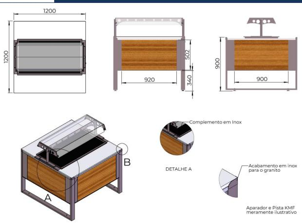
O balcão desmontável é um equipamento versátil e funcional para uso em sistemas de distribuição de alimentos. Sua estrutura em aço inox e pés em perfil tubular inoxidável garantem a resistência e durabilidade do equipamento. A bancada em aço inox ou granito proporciona uma superfície higiênica e fácil de limpar.
