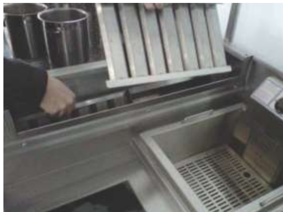
(8º) É importante que os filtros sejam encaixados corretamente.
