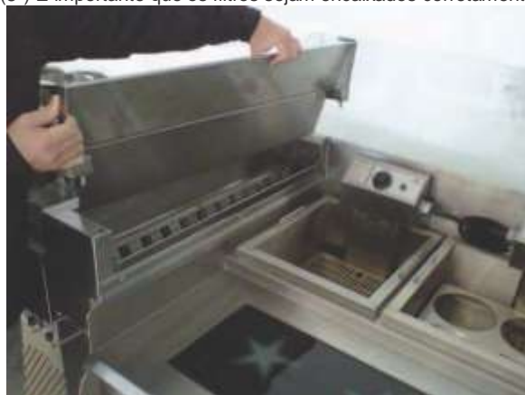
(10º) Encaixe novamente o defletor de ar em seu lugar de origem.
