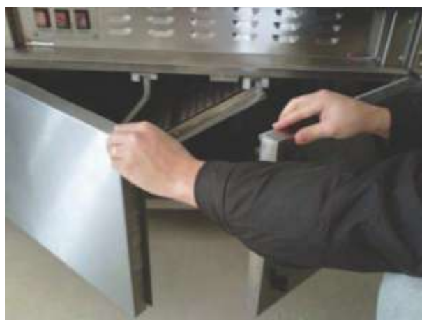
(1º) Para ter acesso aos filtros depuradores é preciso destrancar os dois trincos frontais e abrir as portas que vedam o compartimento onde ficam os filtros depuradores e o motor de exaustão.
