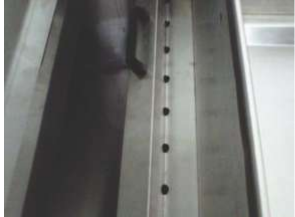
(6º) Após lavar e secar encaixe a gaveta coletora no lugar.
