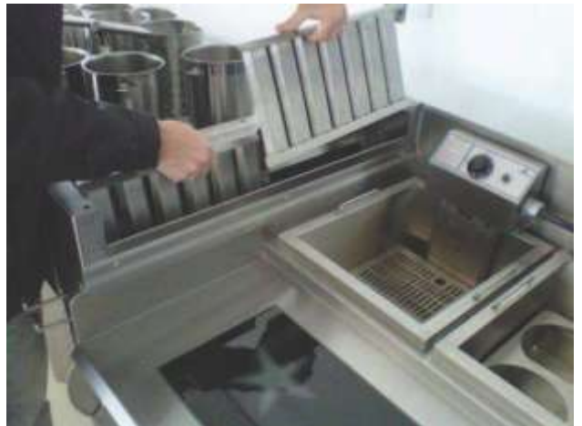
(2º) Retire com cuidado o par de filtros de gordura um por vez.
