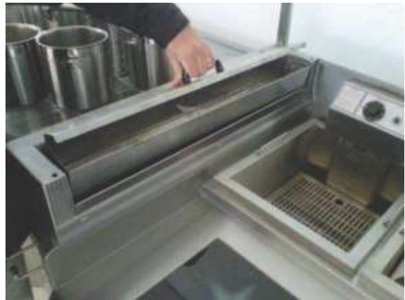
(4º) Retire a gaveta coletora de resíduo puxando-a pela alça.
