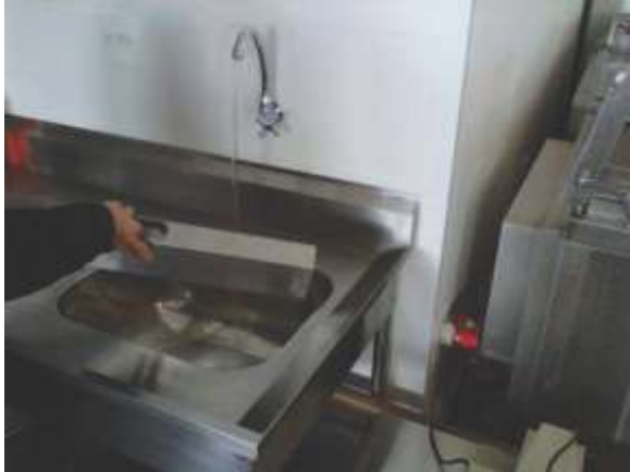
(5º) A gaveta coletora pode ser lavada com água e sabão.
