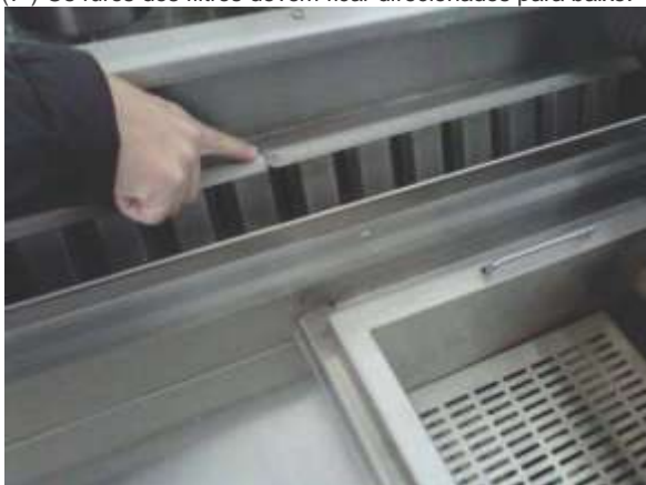
(9º) Verificar o posicionamento e o perfeito encaixe dos filtros.
