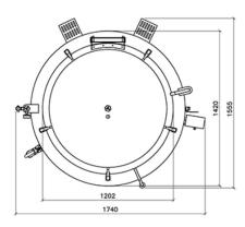
Modelos AC a Gás: tampa modelo autoclavada (com pressão na parte do cozimento).
